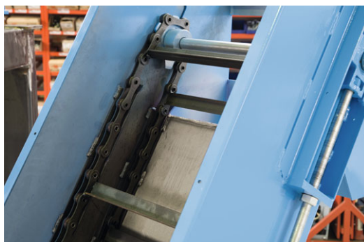
Transportador raspador: vista das correntes laterais e dos arrastadores
