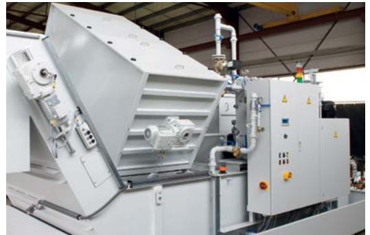
Filtro de tambor STF en un sistema centralizado
