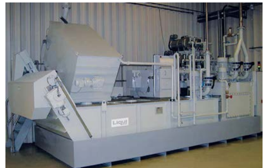
Filtro de tambor STF como prefiltro de aluminio + LIQUI DISC-O
