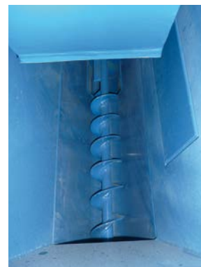
Vista detallada de la esclusa de virutas
