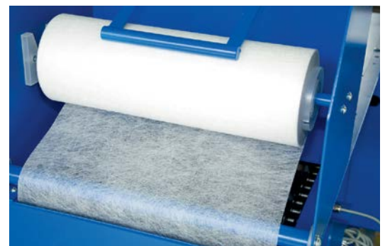
Filtro de tela en filtro de banda por gravedad
