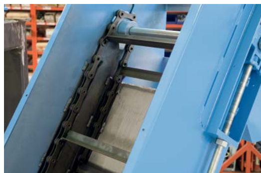
Cinta rascadora: vista lateral de cadenas y arrastradoras
