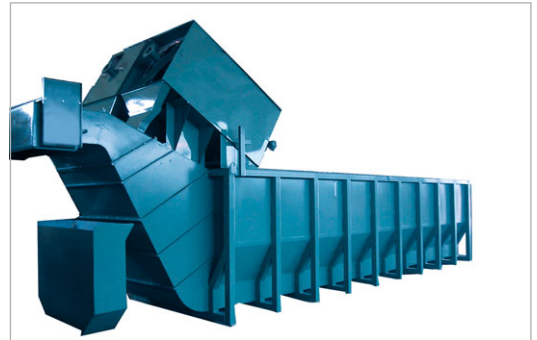
Siebtrommel auf Reinbehälter mit eingebautem Kratzerförderer
