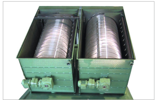
Siebtrommel mit Edelstahlsieben und Düsenstock
