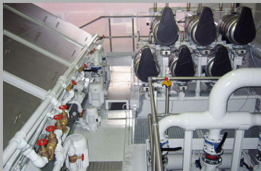
用于在组合设备上进行精细过滤的 Disc-O 过滤机®
