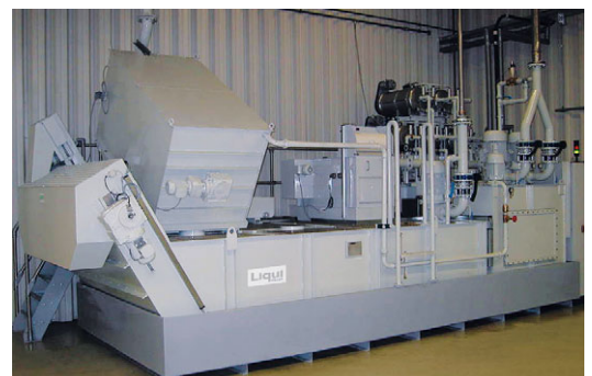
转鼓过滤机作为粗滤或初滤器
