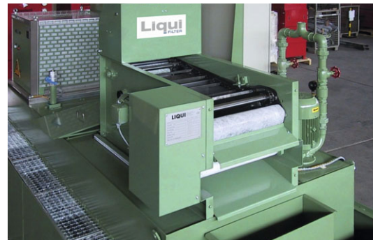
配有滤布/链条的 MTBF-V 型弧网过滤器
