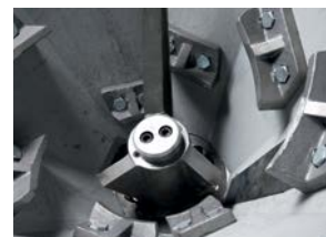
Câmara de moagem com eixo do britador
