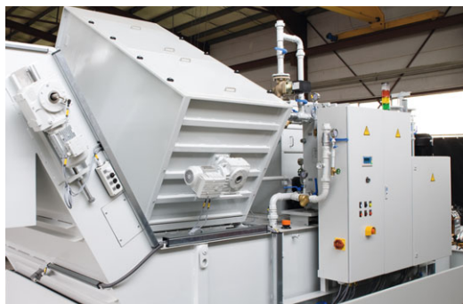
Tambor peneirador em instalação combinada
