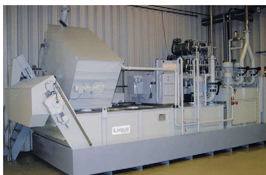
Filtro com tambor peneirador, como filtro grosseiro ou pré-filtro
