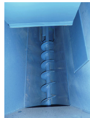
Vista detalhada da comporta de limalhas
