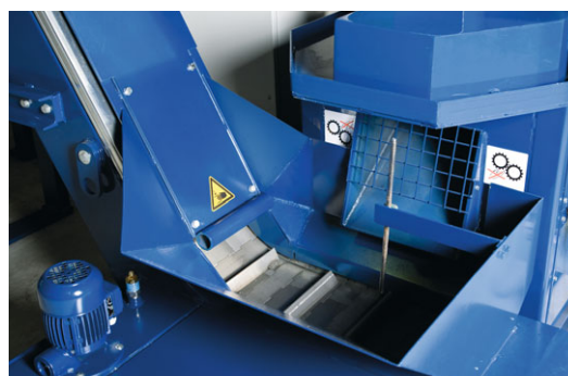
Transportador de placas articuladas: Vista detalhada do canal de transporte
