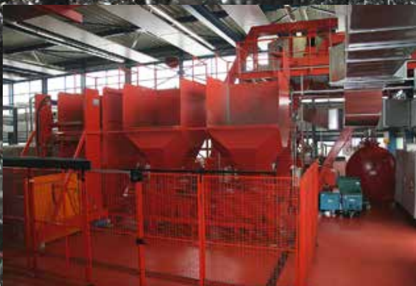
Sortenrein und weniger als 2 Prozent Restfeuchte. Die Späne-Aufbereitungsanlage von Liqui sorgt bei Motherson Orca dafür, dass die produzierten Späne als hochwertiges Gut vermarktet werden können.
